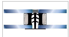
Abb. 3.12: Variante 2 a: Stoßfuge (2-fach IG) (Prinzipdarstellung) [1]
