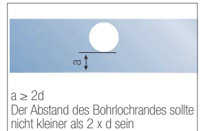
Abb. 11.12: Lage des Bohrlochs zur Ecke
