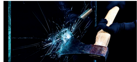
Abb. 7.5: Durchbruchversuch mit Axt
