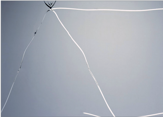
Abb. 2.6: Bruchbild Teilvorgespanntes Glas (TVG)
